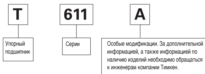
Рис. 41. Система обозначений упорных конических подшипников.
