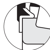
Рис. 2. Контакт широкого торца внутреннего кольца и упорного заплечика вала (без контакта с уплотнением).
